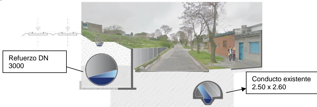
Figura 4 - Sección perpendicular a la vía entra las calles Aguiar y Capitán Florencio
