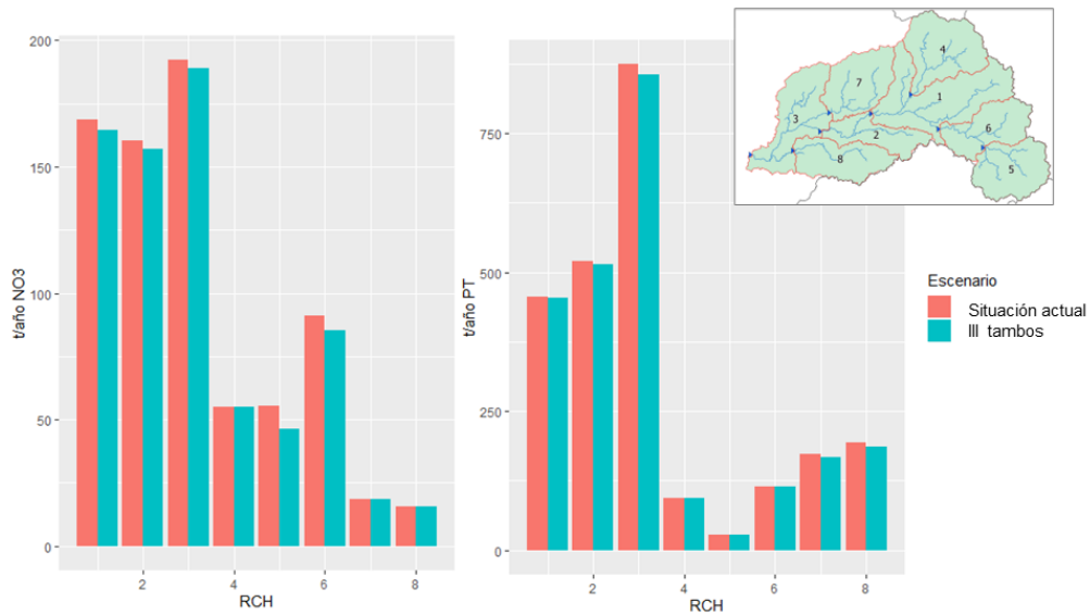
Figura 5. Comparación de cargas en el curso en el escenario base y el escenario III de disminución de aporte de tambos por subcuenca para nitratos y fósforo total. Cada curso de agua (RCH) está numerado según la salida de la cuenca a la cual corresponde.
