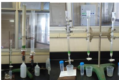
Figura 1 Equipo de filtración, izquierda columnas de acrílico y derecha columnas de vidrio
