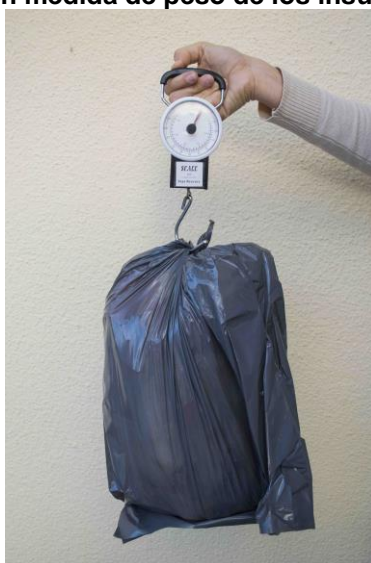
Figura 1. Balanza utilizada en medida de peso de los insumos y residuos.
