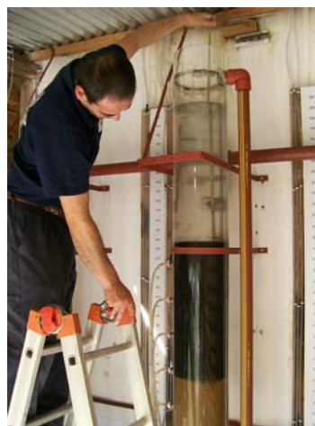
Imagen 10: manto filtrante expandido 12% aprox. durante el lavado Filtro N°2
