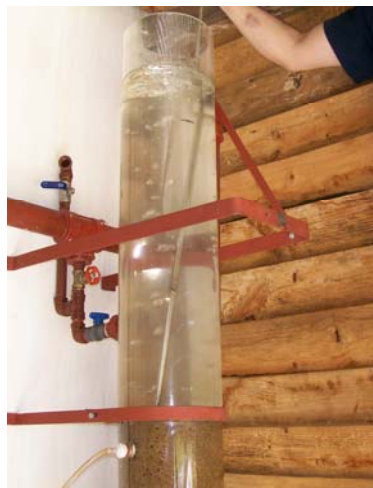
Imagen 9: verificación pinchando el tope del manto (expulsa aire)
