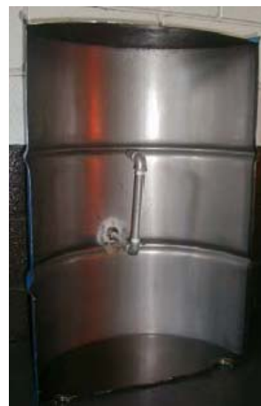
Ilustración 2.b) Sistema desarrollado para la calefacción de las cunas de lechones.
