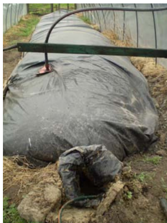
Ilustración 2.a) Biodigestor de polietileno, con invernadero para mejorar el aislamiento térmico.
