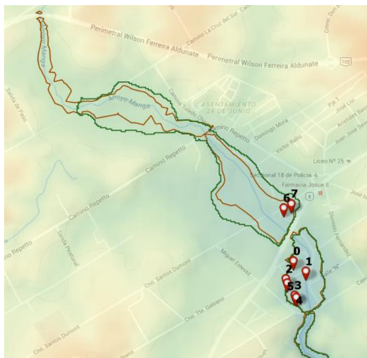
Figura 5.- Superficies de inundación para Febrero 2014 de ambos modelos (verde: Mike, marrón: HEC), y puntos de calibración
