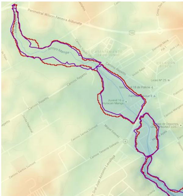
Figura 8.- Superficies de inundación obtenidas con el HEC-RAS (violeta) y MIKE URBAN (roja) - TR 100
